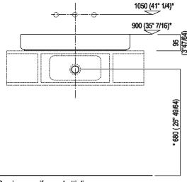
Scarico per sifone a bottiglia Drain for bottle trap
